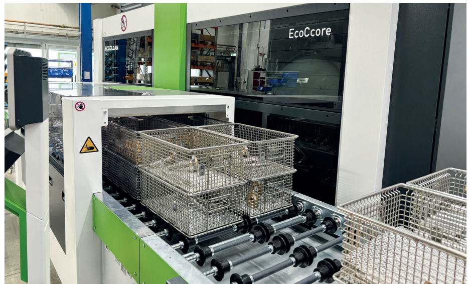
Die neue Entfettungsmaschine arbeitet nicht mit PER, sondern mit modifiziertem Alkohol; das ist wesentlich umweltfreundlicher.
